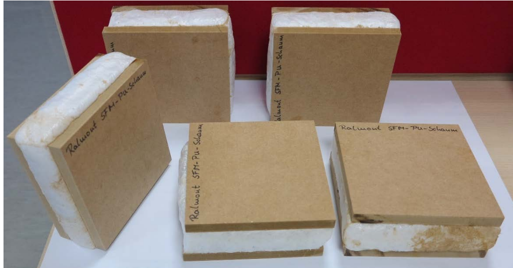
Abbildung 2: Ansicht der Probekörper D5 bis D9 mit einer PU-Schaum-Nenndicke von 40 mm
